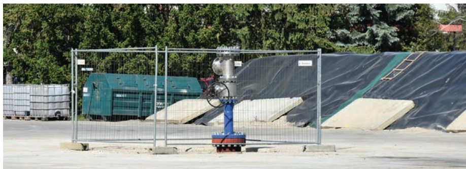
// W miejscu wiertni pozostała głowica odwiertu przygotowana do pompowania wody
